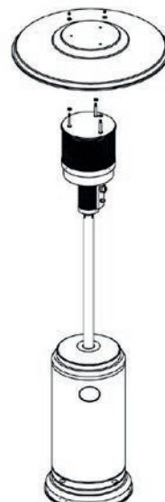
**NL** Schuif de behuizing omhoog en laat deze op de 3 bevestigingsbeugels rusten.
